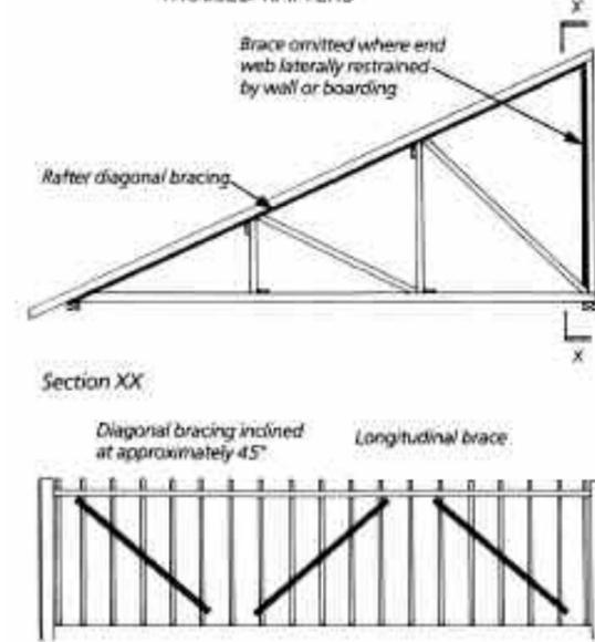
FIGURE 7.07 DIAGONAL BRACING ON STUBBED TRUSSED RAFTERS
